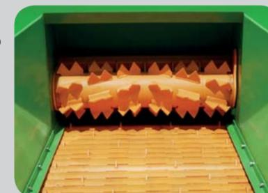
←... tapete de alimentação robusto e de baixo desgaste - Rolo de alimentação agressivo com abertura até 30 cm!
