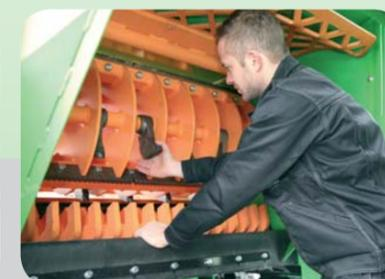
←... Rotor potente com ferramentas de substituição rápida
